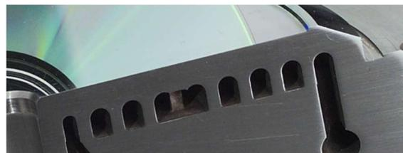
Gelötete Formplatte mit optimierten Kühlkanälen
